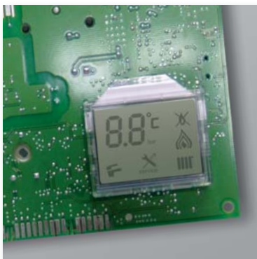
Scheda elettronica HONEYWELL con microprocessore
